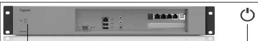
**4** Porniți Gigaset T500 PRO cu ajutorul butonului de pornire (în partea frontală a aparatului).
